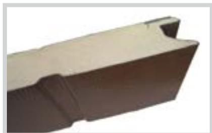
Образец немецкой панели до и после приложения ручного усилия на разрыв
