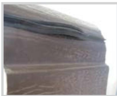
Выталкивание уплотнителя верхней панелью в стыке с защитой от защемления пальцев
