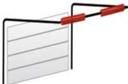
Ворота, в которых уравнивание полотна осуществляется торсионным механизмом с задним расположением вала (используется при низкой притолоке)
