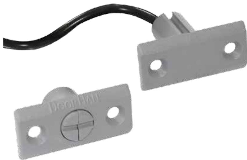
Магнитный бесконтактный датчик WDKIT предназначен для обеспечения безопасного использования ворот с врезной калиткой. При открытой калитке сигнал с датчика блокирует работу привода, предотвращая движение ворот.
