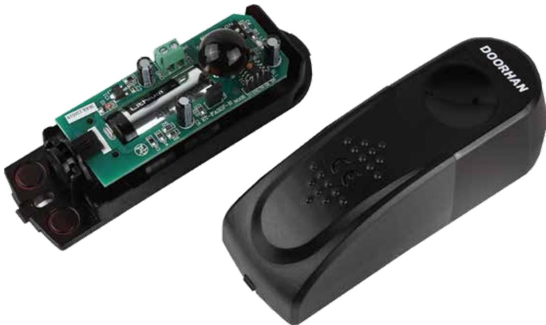
Фотоэлементы Photocell-W — устройство, состоящее из инфракрасного передатчика и приемника, которые устанавливаются в проем автоматических ворот для обеспечения максимальной безопасности их использования.
